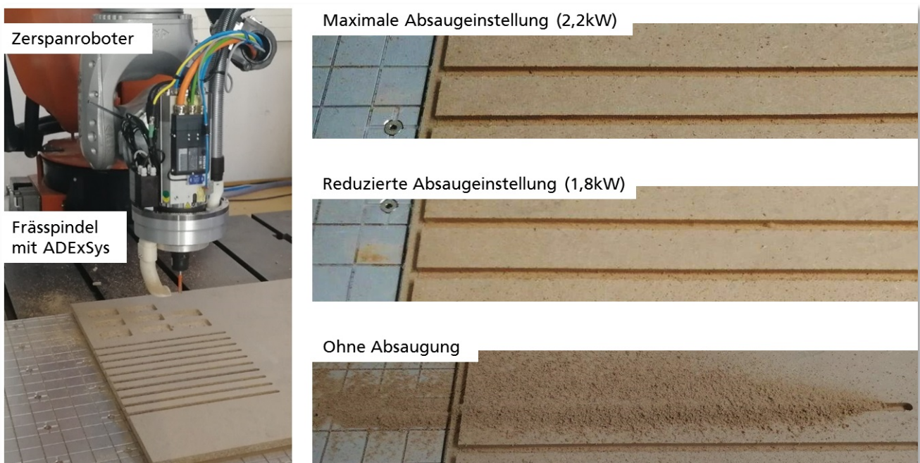
Abbildung 3: Absaugsystem ADExSys für eine werkzeugnahe Absaugung, Erfassung der Späne bei unterschiedlichen Absaugeinstellungen
